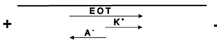
Obr. č. 19.2.: Migrační poměry v kapiláře. EOT - elektroosmotický tok, \text{K}^+ - kationty, \text{A}^- anionty
