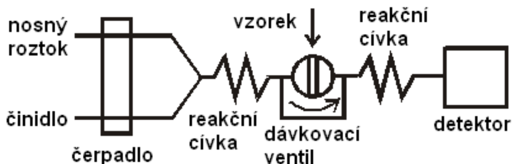
Obr. č. 14.2.: Schéma aparatury pro průtokovou injekční analýzu
